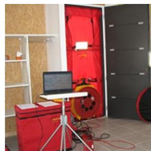
**La mesure :** L'objectif est de quantifier la perméabilité à l'air de l'enveloppe. Pour cela, un équipement spécifique appelé porte soufflante est utilisé, afin de produire une différence de pression entre l'intérieur et l'extérieur du bâtiment.
